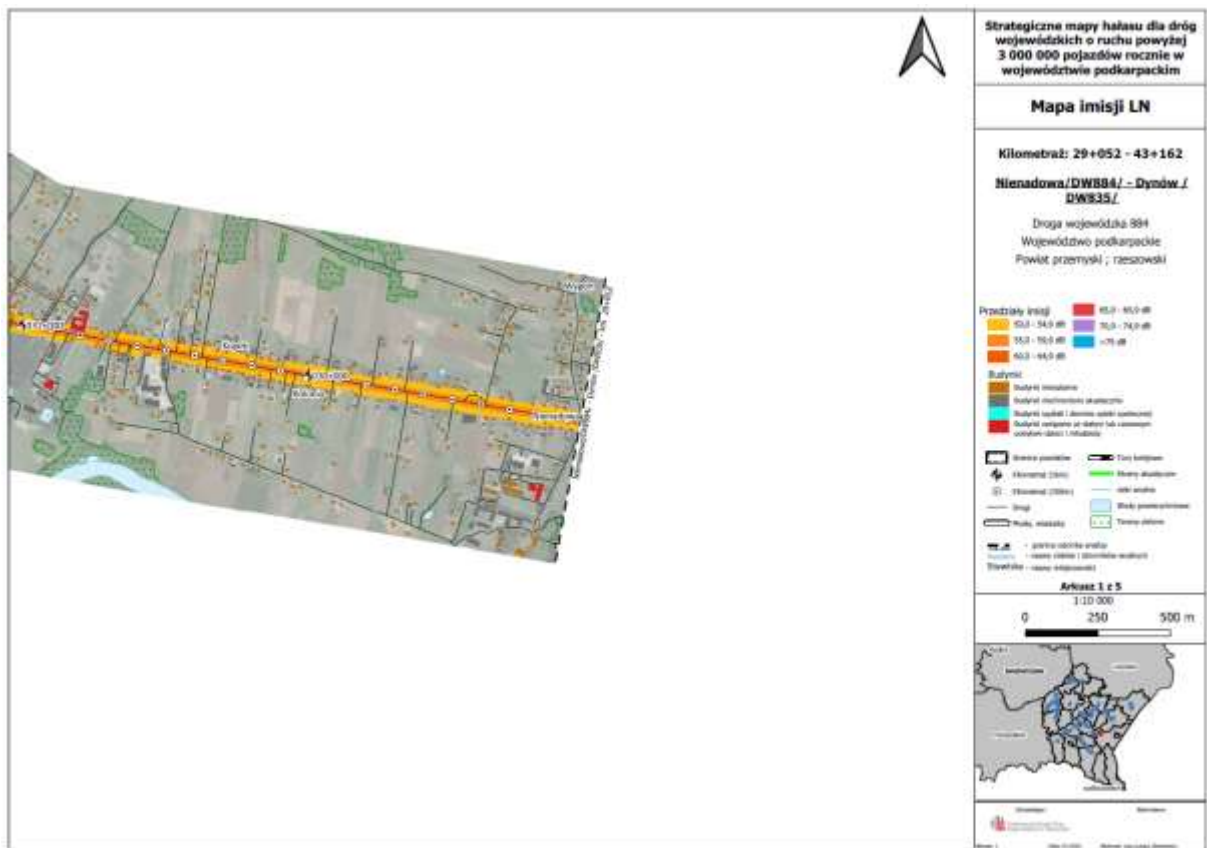
Rysunek 18. Mapa emisji wskaźnika L N na obszarze objętym mapą akustyczną położonym najbliżej gminy Krzywca 25
